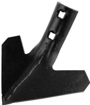
Bei unserem Gänsefußschar beschichtet handelt es sich um ein gängiges Standardschar, welches in sehr vielen Betrieben läuft. Wir haben uns bewusst für die Stärke von 6 mm entschieden, um ein stabiles Schar garantieren zu können. Durch die flache Konstruktion hat das Schar eine gut Schneidfähigkeit und ist durch den günstigen Preis sehr beliebt. Durch eine DUR-Beschichtung an der Hauptangriffsfläche können wir eine deutlich längere Standzeit als beim Standardschar erzielen.
